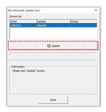
・更新が完了したら、Information 内の指示に従って MicroPeckerX を再接続し、Close を選択します。 これでファームウェアの更新は終了です。MicroPeckerX Update Tool を終了してください。
