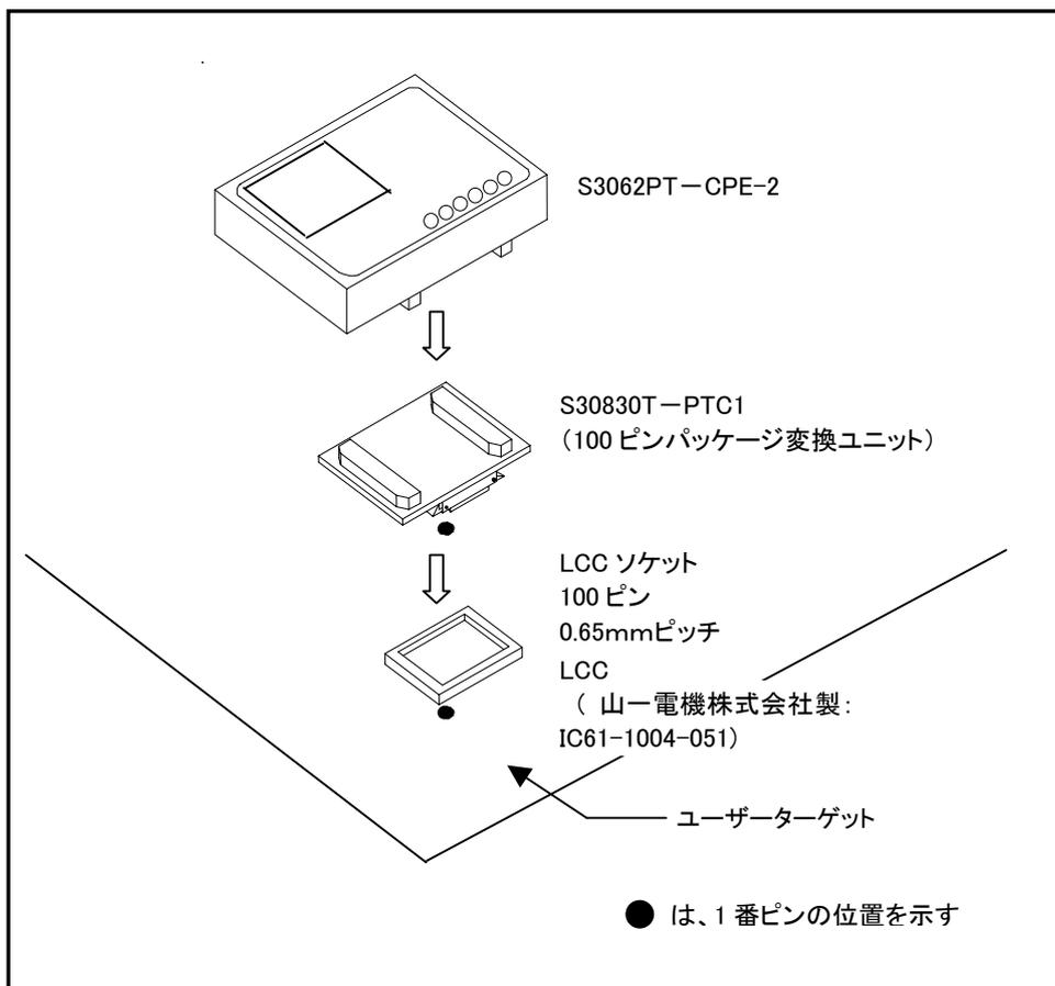
図 2.8 100ピン LCC ソケットへの接続
