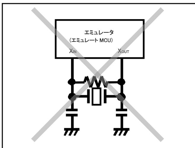
図 3.6 エミュレータでは発振しない回路
