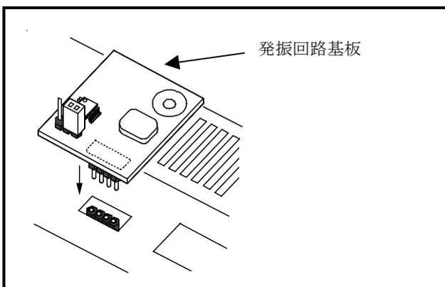
図 3.4 発振回路基板 (S30830T-OSC1) の装着方法
