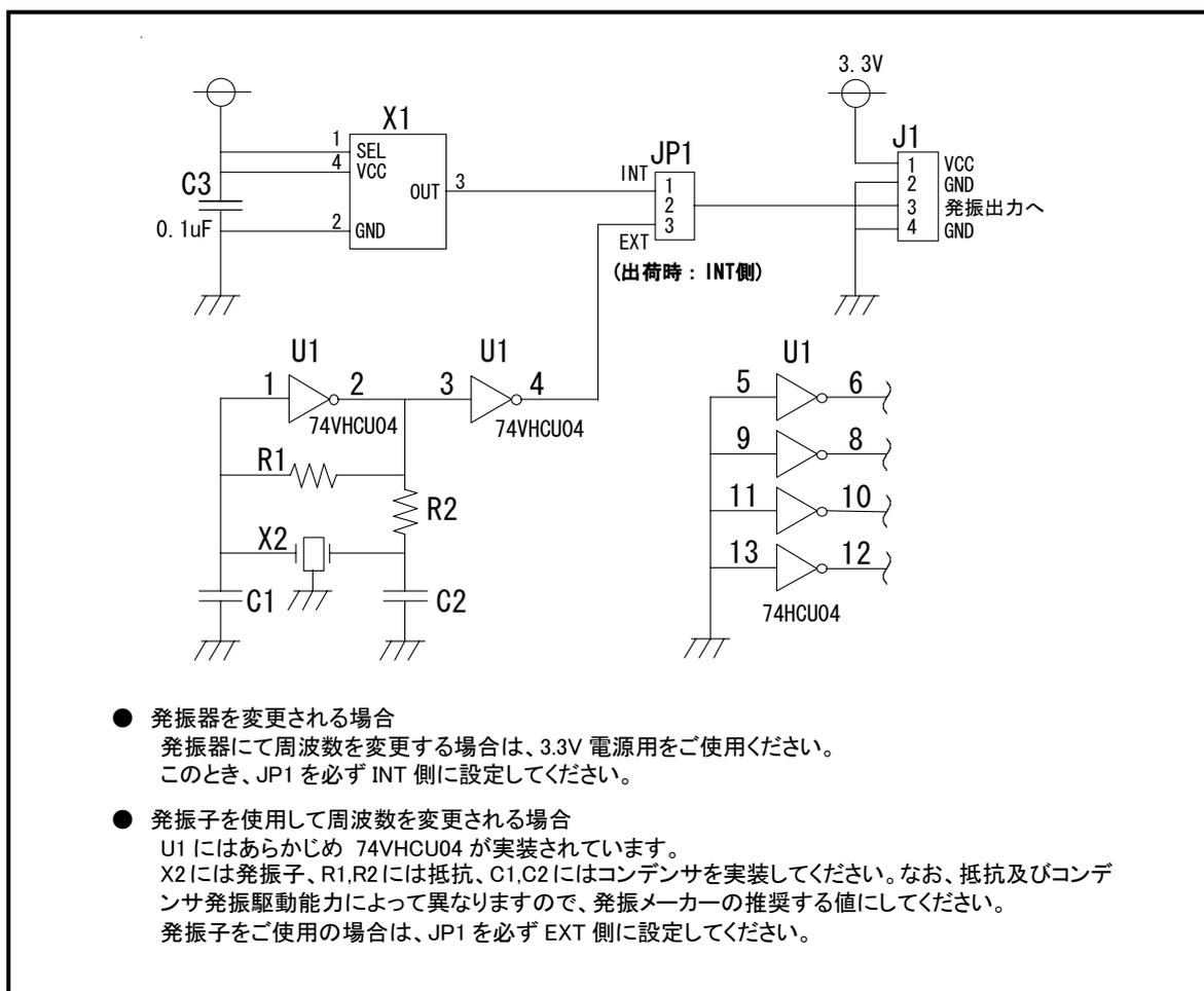
図 3.2 発振回路基板 (S30830T-OSC1) の回路
