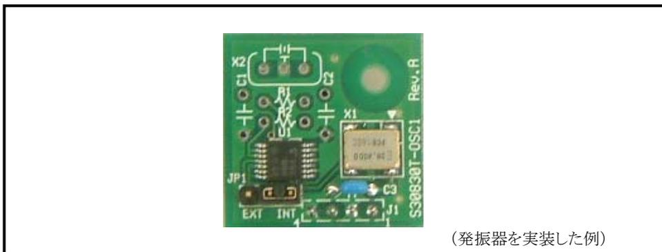
図 3.1 発振回路基板 (S30830T-OSC1) の外形
