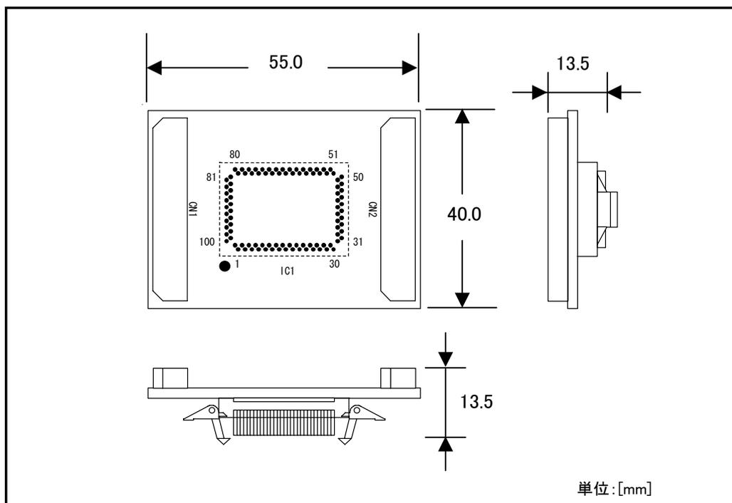
図 4.4 パッケージ変換ユニット寸法図
