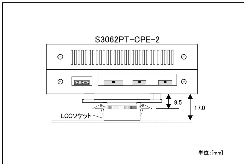
図 4.5 対ターゲット基板寸法図
