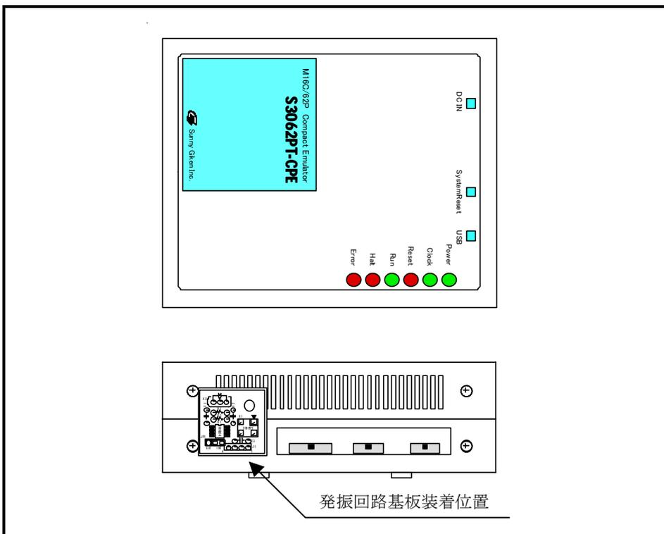
図 3.3 発振回路基板 (S30830T-OSC1) の装着位置
