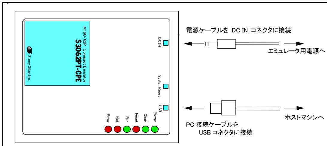
図 2.4 エミュレータシステムの接続
