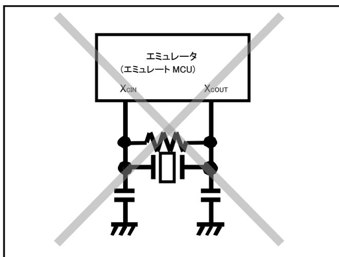
図 3.8 エミュレータでは発振しない回路
