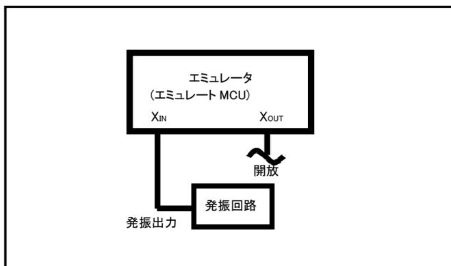
図 3.5 ターゲットシステム発振回路
