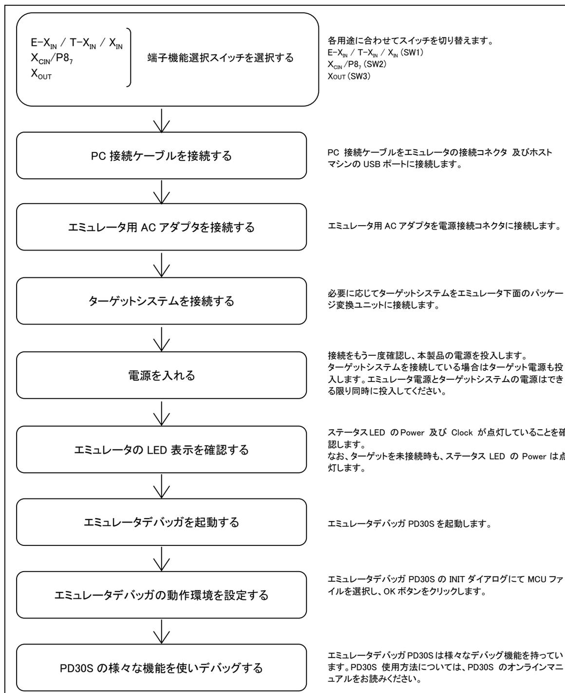
図 2.3 エミュレータ起動までの流れ
