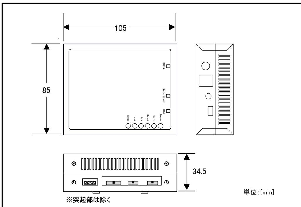
図 4.3 エミュレータ寸法図
