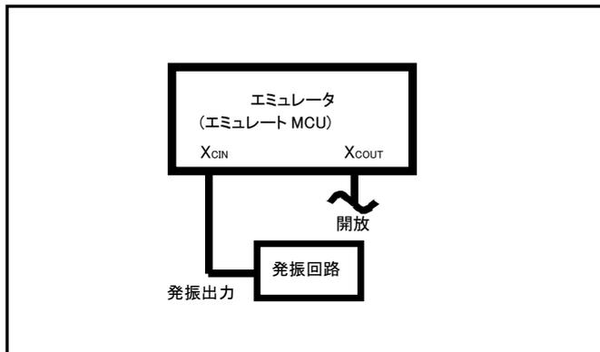
図 3.7 ターゲットシステム発振回路
