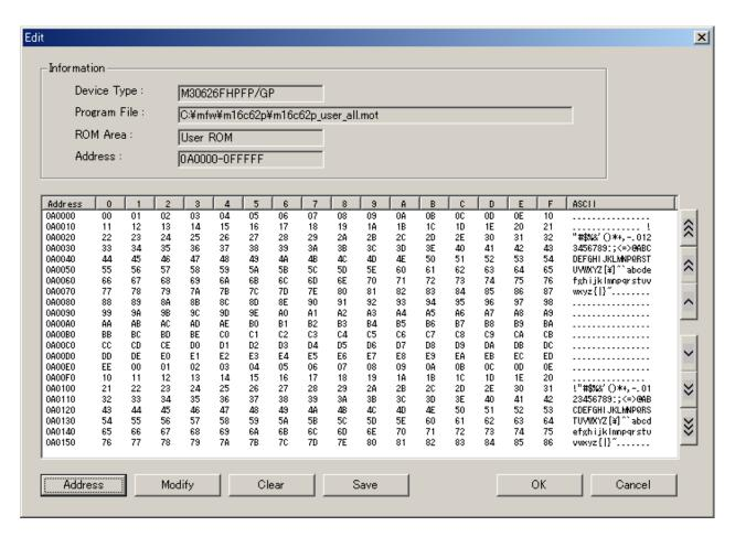
メモリのダンプアドレスはダンプ画面の右端にある矢印ボタンをクリックして切換えることができます。上向き矢印はアドレスを戻し、下向き矢印はアドレスを進めます。戻したり進めたりする量は矢印の数により、1つの場合は $\pm$ 100H、2つの場合は $\pm$ 1000H、3つの場合は $\pm$ 1000H、2つの場合は $\pm$ 1000H、3つの場合は $\pm$ 1000H、2つの場合は $\pm$ 1000H、3つの場合は $\pm$ 10000H になります。
