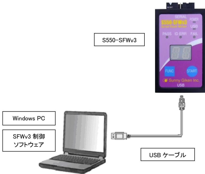
※ S550-SFWv3 の電源の ON/OFF は USB ケーブルの脱着により行います。
